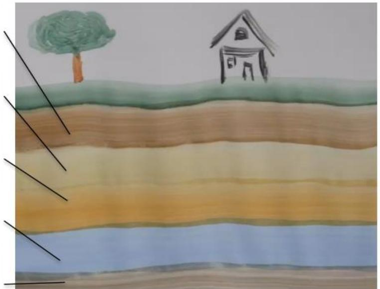
Grundwasser // Humus // Kies // Sand // wasserundurchlässige Schicht
